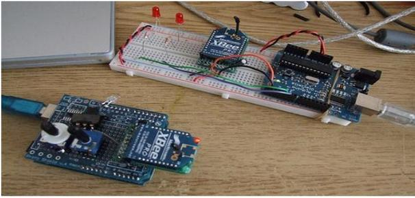
ARDUINO - XBEE    →    DATA    →    XBEE - ARDUINO
