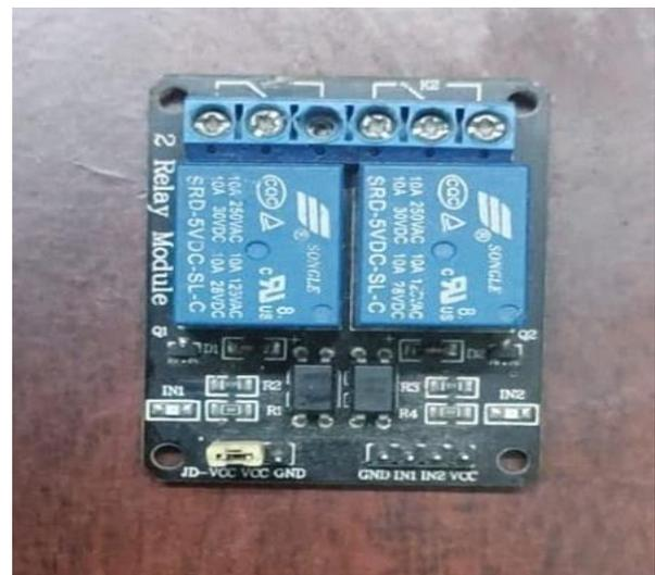
**Fig. 5. Relay module**
