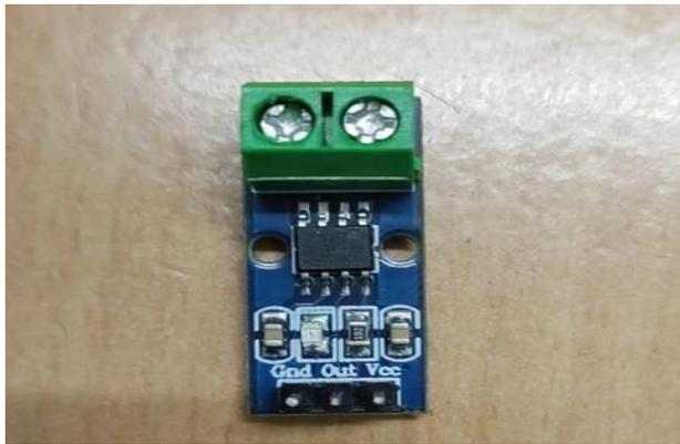
Fig. 7.ACS712 Sensor module
