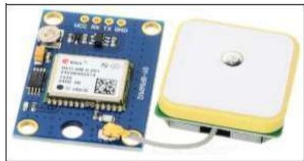
Fig. 9. GPS module NEO 6M-0-001 [14]
