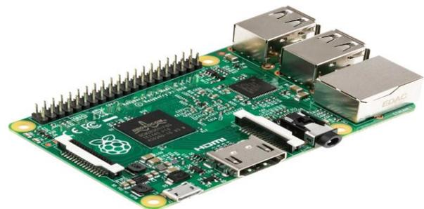
FIG 3. Raspberry pi 3 module
