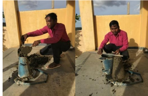
Fig No: 11 Slump Test
