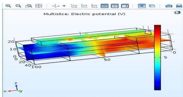
Fig: 3 SG-MOSFET at 5V
