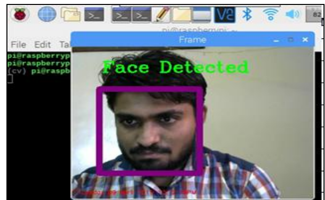
Fig. 6 Face Detection using Haar Cascade
