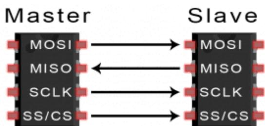
FIG6 . SPI DIAGRAM
