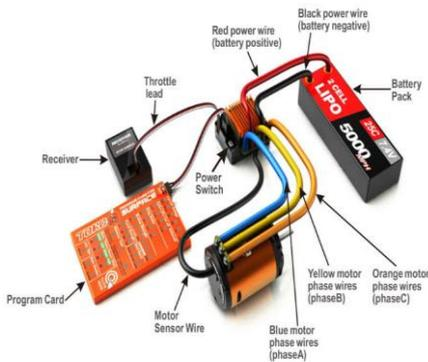
Fig9.ELECTRONIC SPEED CONTROLLER
