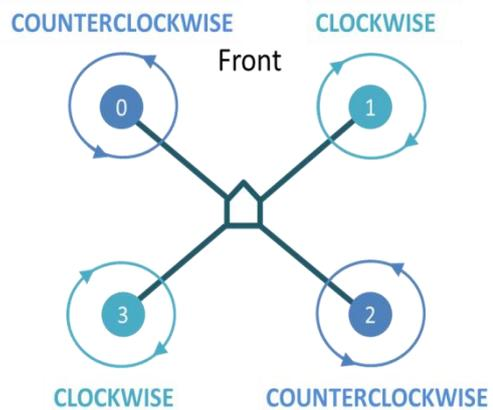
Fig 11 . OPERATION OF AERODRONE
