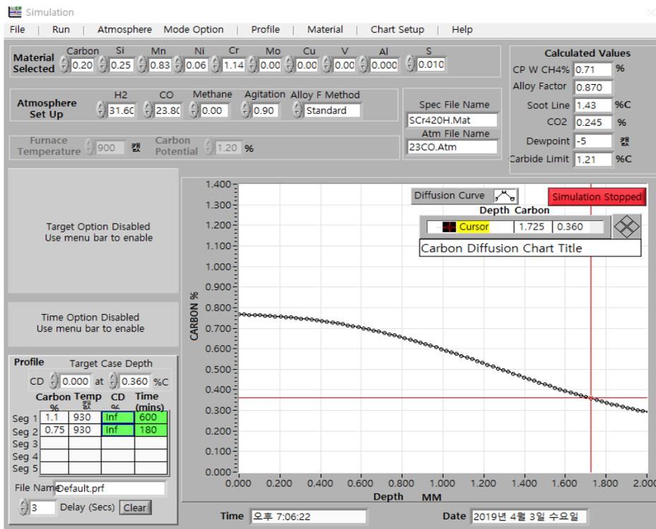
Fig. 6 (c) Carburizing CP 1.10wt%, Diffusion CP 0.75wt% (T3).
