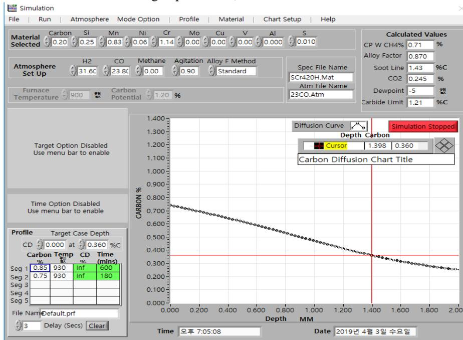
Fig. 6(a) Carburizing CP 0.85wt%, Diffusion CP 0.75wt% (T1).
