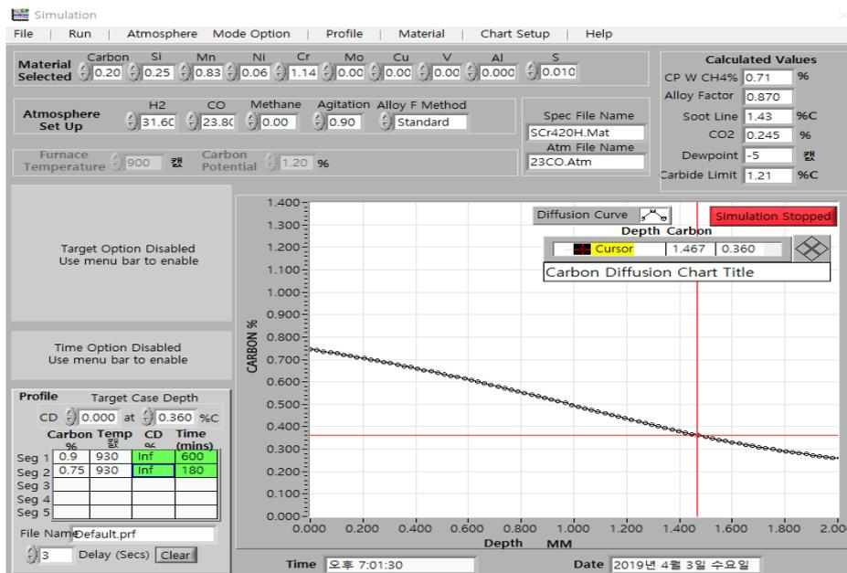
Fig. 6 (b) Carburizing CP 0.90wt%, Diffusion CP 0.75wt% (T2).
