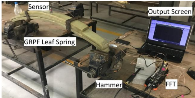
Fig. 8 FFT Analyzer Test Rig
