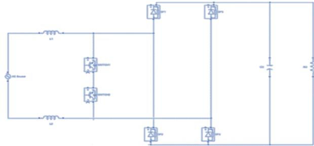
Fig. 4. BTBBL PFC Rectifier
