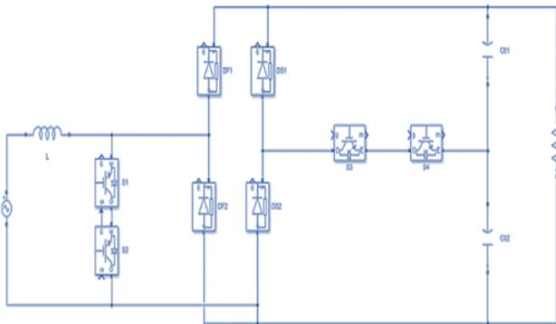
FIG.7. FMBL PFC RECTIFIER
