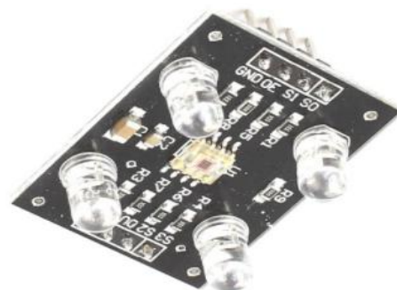
Fig. 2. TCS3200 color sensor module
