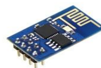
Fig. 3: ESP8266-01 Wifi Module
