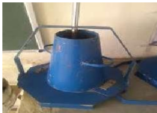
Fig.2. Slump Cone Test
